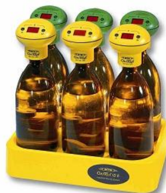
Figura 2: Sistema Oxitop (Fonte: Clarkson Laboratoy, 2020).
